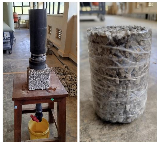
(d) Permeability test
